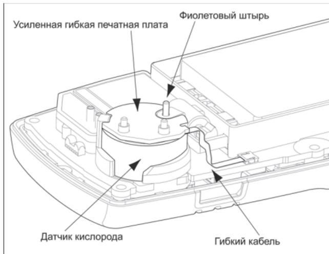
2. Отметьте расположение печатной платы, чтобы затем правильно установить ее на место. Открутите два винта на печатной плате.
