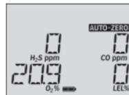
4. Когда **AUTO-SPAN** отображается и
