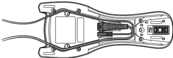
Si opta por guiar los cables a través de la parte superior de la base, asegúrese de cruzar los cables antes de colocarlos en su canalización. En caso contrario, los conectores de los cables se verían sometidos a una presión excesiva.
