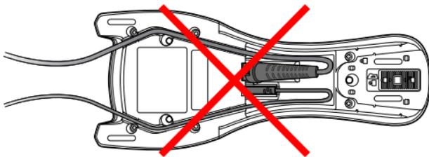
Si monta la base sobre una superficie vertical, debe utilizar un sistema de bloqueo que permite asegurar el escáner mientras se encuentra en la base. Si se monta en una superficie horizontal, el mecanismo de bloqueo deberá desactivarse (palanca colocada en la posición superior). Si se monta en una superficie vertical, el mecanismo de bloqueo deberá activarse (palanca colocada en la posición inferior).
